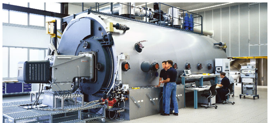
En la cámara de combustión grande se prueban quemadores hasta 32 MW
