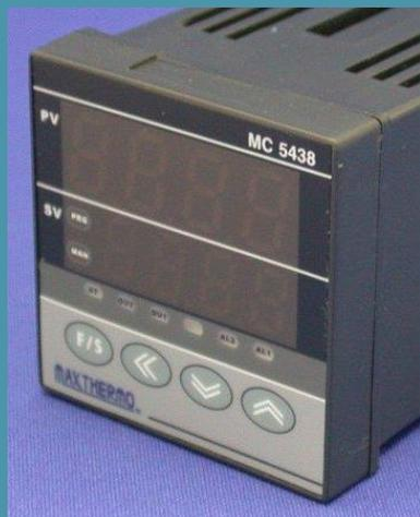
Mantiene la temperatura del aire de recirculación en el interior del horno dentro de límites previamente establecidos en el programador prendiendo y apagando el quemador de gas.
